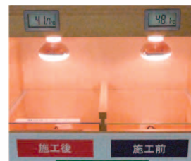
デモ施工中 約7℃の温度差を実現
